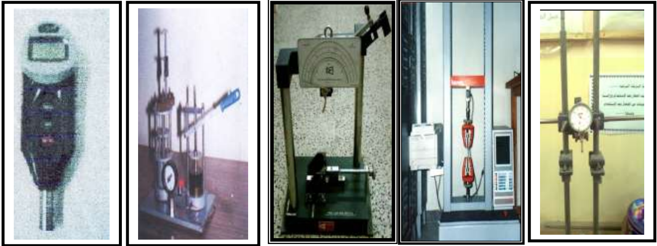
شكل (1) الاجهزة المستخدمة في البحث لاختبارات (الانحناء، الشد، الصدمة، الانضغاطية، الصلادة) على التوالي
