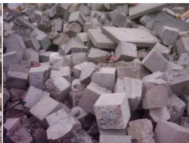
صورة رقم 1 نماذج مكعبات مفحوصة وتالفة
