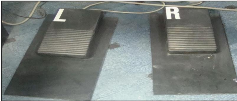
الشكل (٣) صورة توضيحية لدواسات القدم الرقمية (Digital Foot Pedals)
