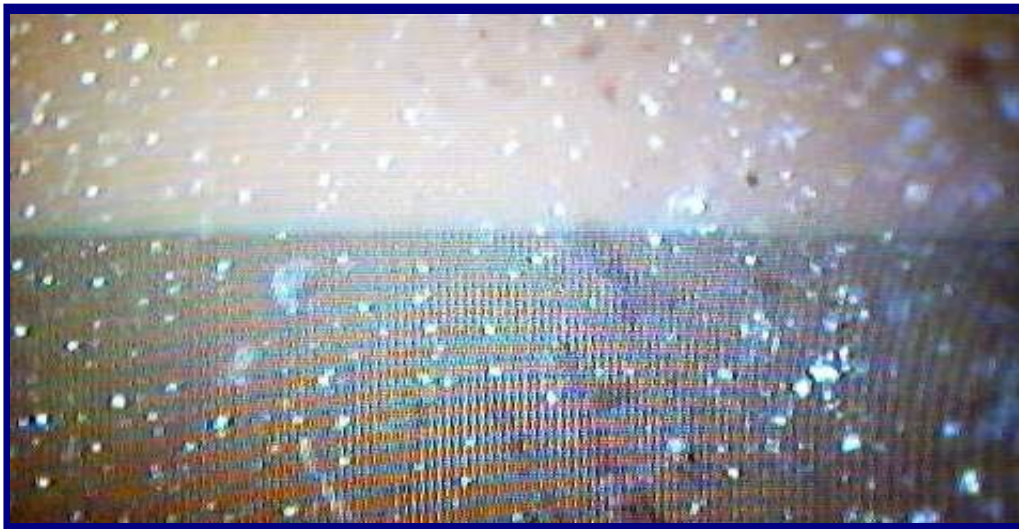
شكل(6): صورة نموذجية للطبقات الفوقية لمينا مخدش بالليزر عند زمن (16 sec) وقدرة خروج (1.5 watt)
