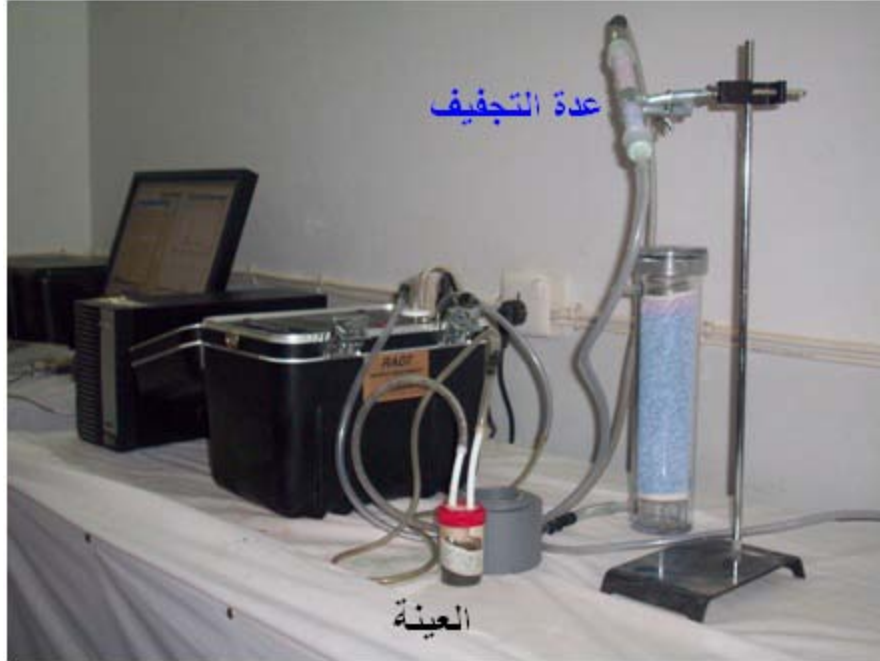
شكل (2) علمية قياس تركيز غاز الرادون والثورون باستخدام RAD7
