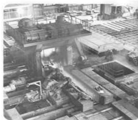
شغل (1) مكائنة درفنة تشغل بوساطة منظومة هيدروليكية بعيدة المصدر [1]
