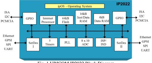
Fig. 1 UBICOM IP2022 Block Diagram
