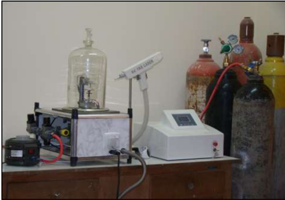
شكل (1) يوضح منظومة ترسيب أغشية ZnS مع منظومة الليزر .
