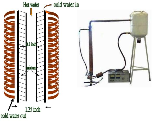
Fig. (1-a) Experimental Apparatus
