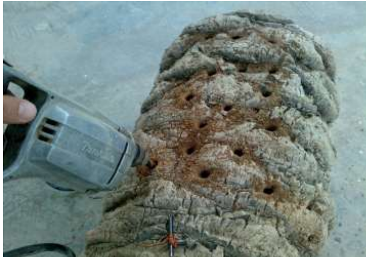
صورة (3) ثقب جذع النخل بواسطة مثقاب كهربائي
