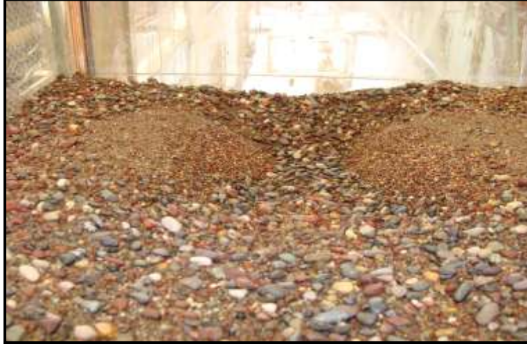
لوحة (1): حفرة النحر مؤخر القنطرة المستطيلة
