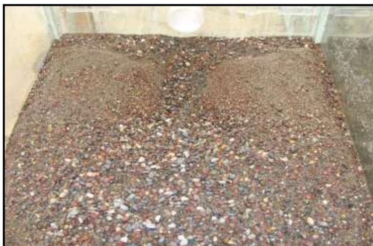
لوحة (5): حفرة النحر مؤخر القنطرة الأنبوبية
