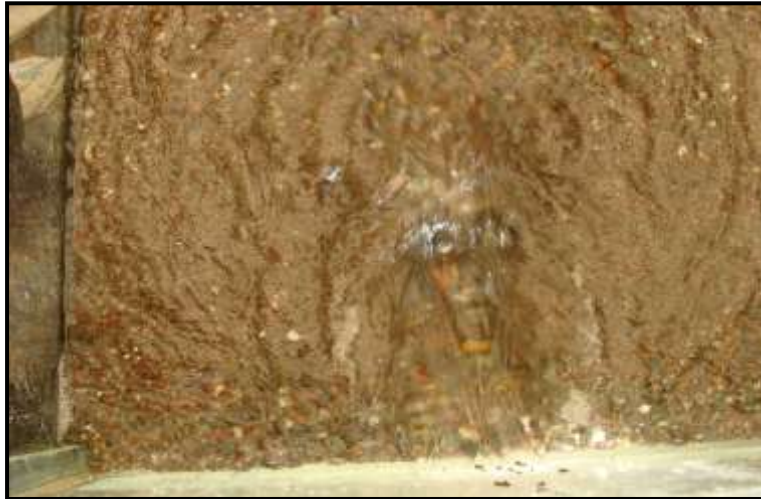
لوحة (2): حركة الماء الخارج من القنطرة المستطيلة لنفس التجربة
