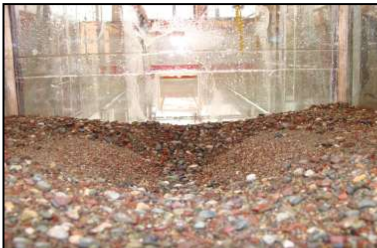
لوحة (3): حفرة النحر مؤخر القنطرة المربعة
