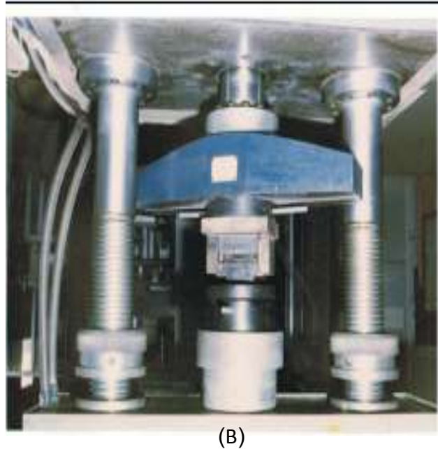
شكل (4) A- يوضح مخطط للمكبس والقالب المستخدم في الاختبارات B- صورة فوتوغرافية للمكبس والقالب المستخدم في الاختبارات
