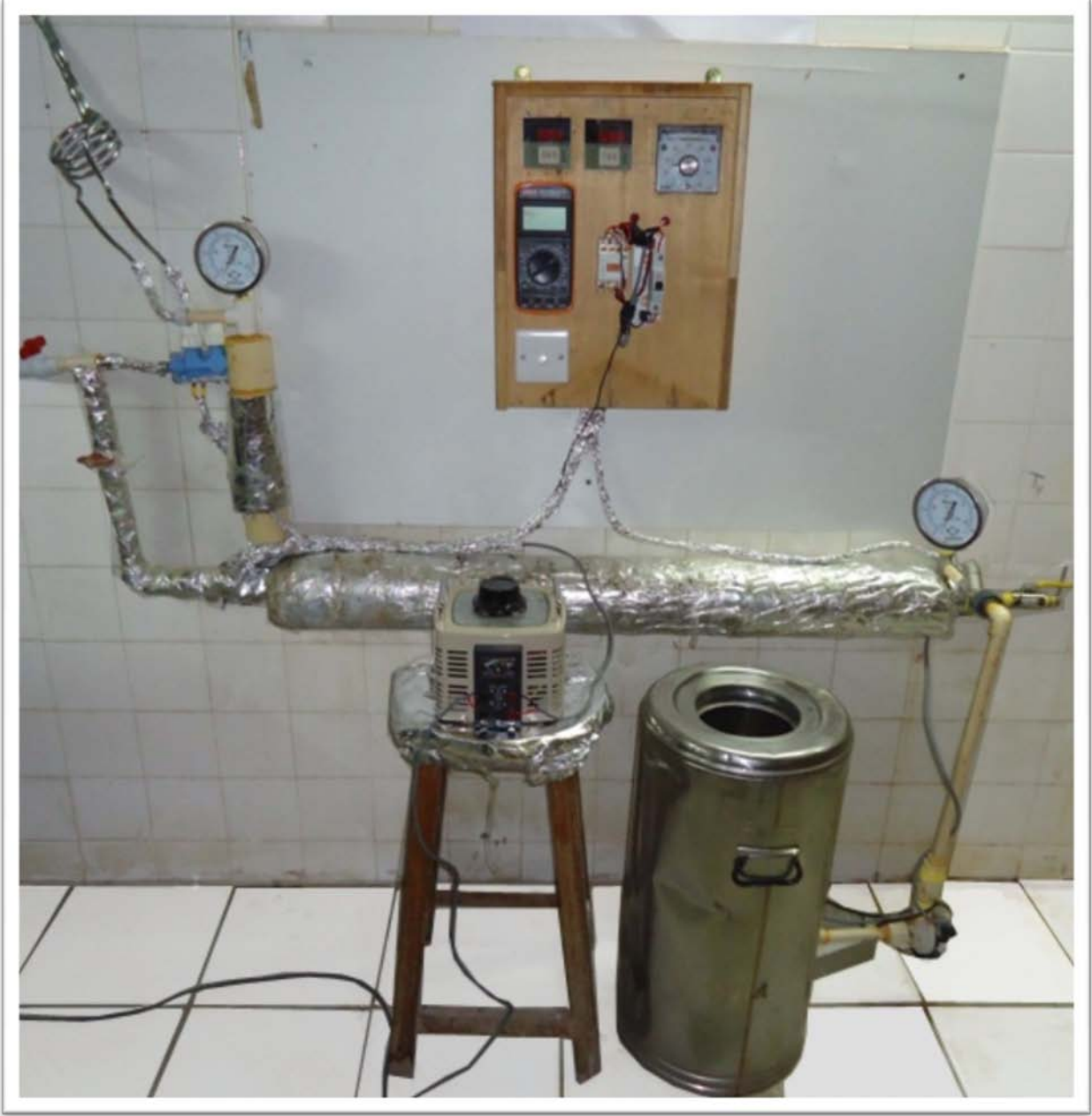
شكل ( 2 ) : صورة فوتوغرافية لجهاز بسترة الحليب بالتسخين الاومي .
