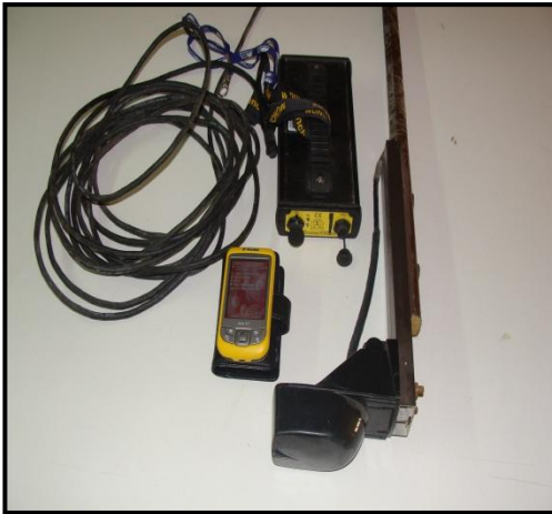
الشكل (3) : جهاز قياس الاعماق ( Echo Sounder ) المستخدم في قياس طوبوغرافية قاع المقاطع
