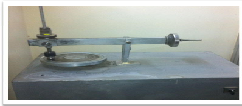
الشكل (1) يوضح جهاز البلى الانزلاقي الجاف
