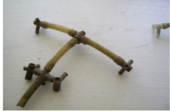
الشكل (١) الجهة الخلفية من آلية تحريك المياه التي ترتبط بمضخة الماء لتحريك المياه تحت نبات عدس الماء من دون أن تظهر حركة المياه.
