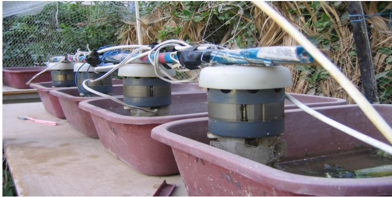
الشكل (٣) المنظومة متكاملة ومرتبطة بمنظم للوقت يعمل ويتوقف بشكل متناوب لمدة نصف ساعة.
