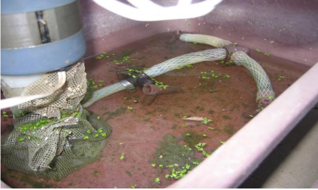
الشكل (٢) آلية تحريك المياه مع المضخة ويظهر المشبك حول المحور الدوار للمضخة لحماية النبات من الانتقال خلاله ولتجنب تأثير ذلك على التجربة.
