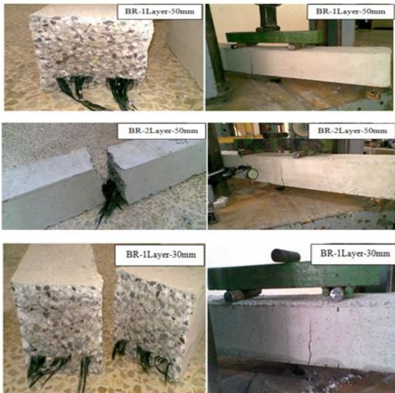
الشكل (9): يوضح شكل الفشل للعتبات الخرسانية المسلحة داخلياً بألياف الكربون
