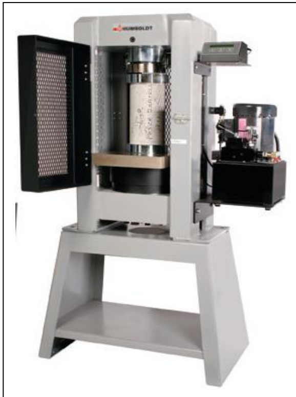
الشكل (3) جهاز قياس مقاومة الانضغاط (compressive strength) المستخدم في العمل
