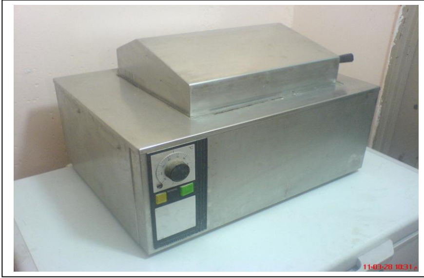
الشكل (2) الحمام المائي (water path) المستخدم في العمل
