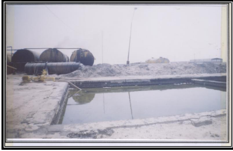
صورة (٥) ترسيب الملوثات الصلبة في خزانات من المياه على سطح الارض في صناعة الاسفلت . التقطت الصورة بتاريخ ٢٠٠٥/٧/٤ .
