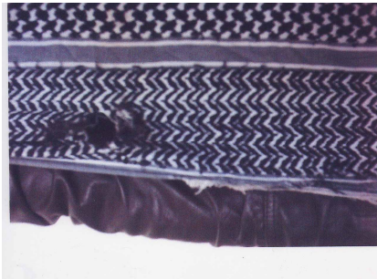
شكل رقم (4) عيب نتيجة سرعة المكوك
