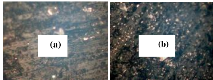
الشكل (6) صور مجهرية للنماذج المغمورة في المحاليل الكيميائية : (a) المحلول الحامضي . (b) المحلول القاعدي .
