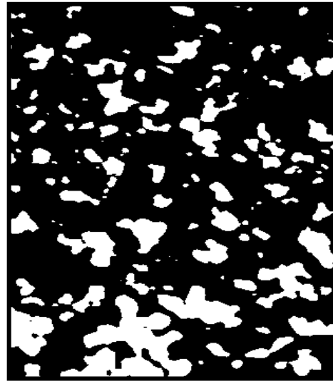
شكل رقم ( 3 ) : يوضح البنية المجهرية للعينة الملدنة شاملاً، قوة التكبير ( 875X )
