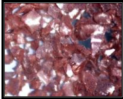
(b) (a) شكل (1) صورة مجهرية لمسحوق الزجاج (a) قبل الطلاء (b) بعد الطلاء اللاكهربائي بالنحاس
