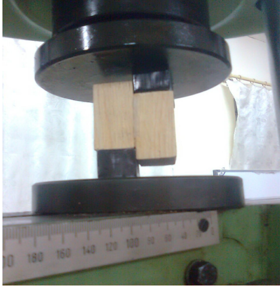
الشكل (٥): طريقة الفحص الميكانيكي لنماذج قوة القص للخط الصمغي
