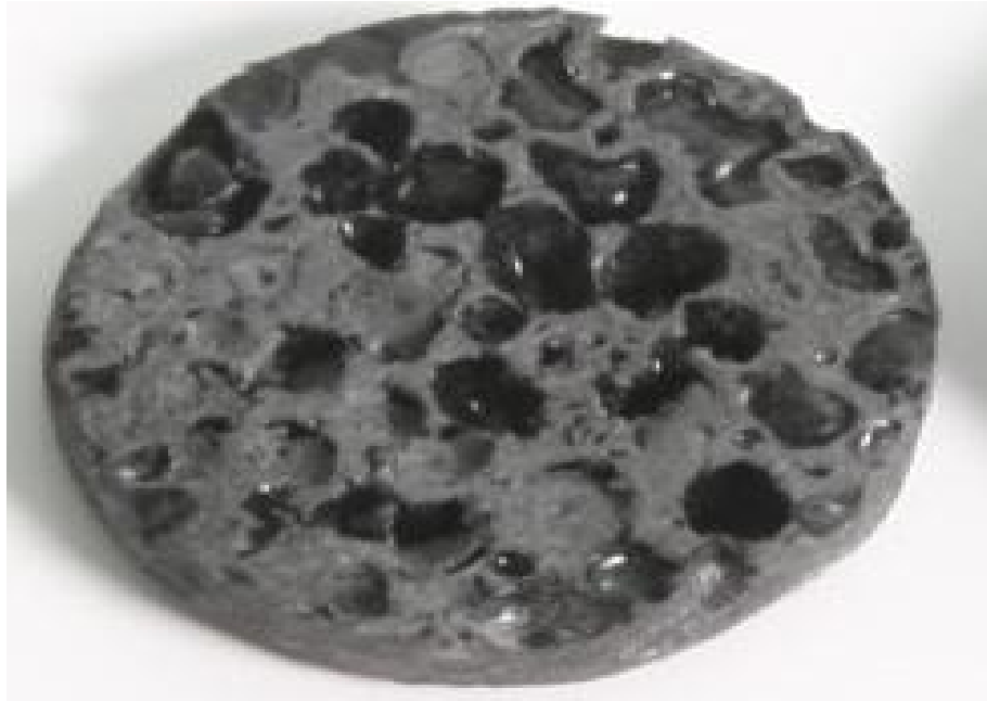
الشكل (6-d) صورة النموذج styropore أضيف اليه (15%) من دقائق الكربون
