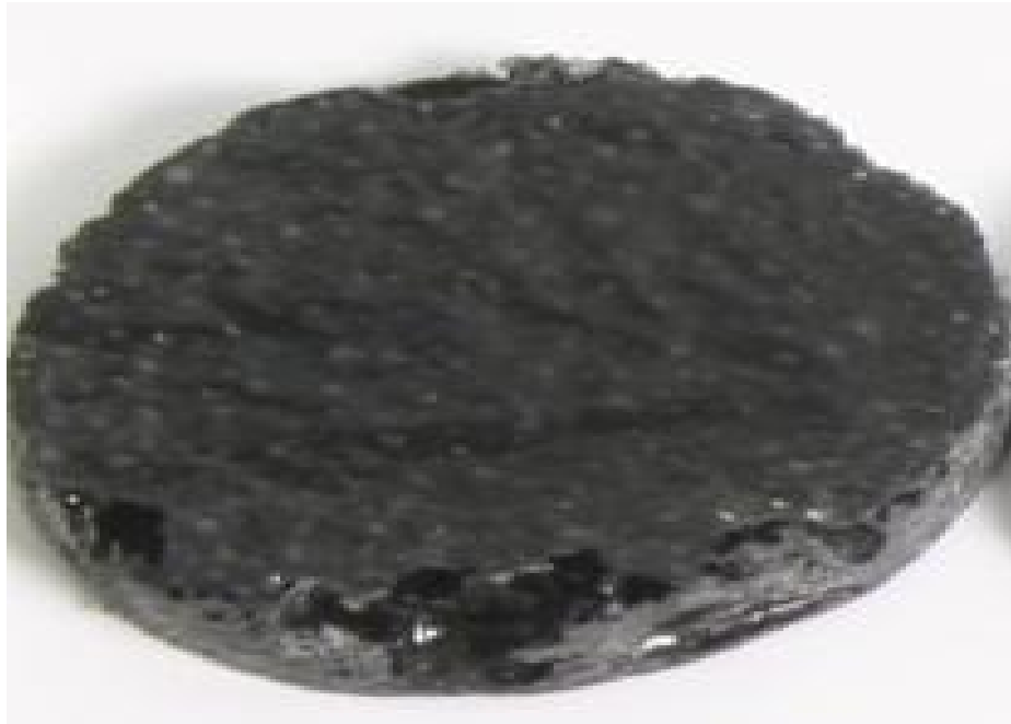
الشكل (6-b) صورة لنموذج styropore أضيف إليه (2.5%) من دقائق الكربون
