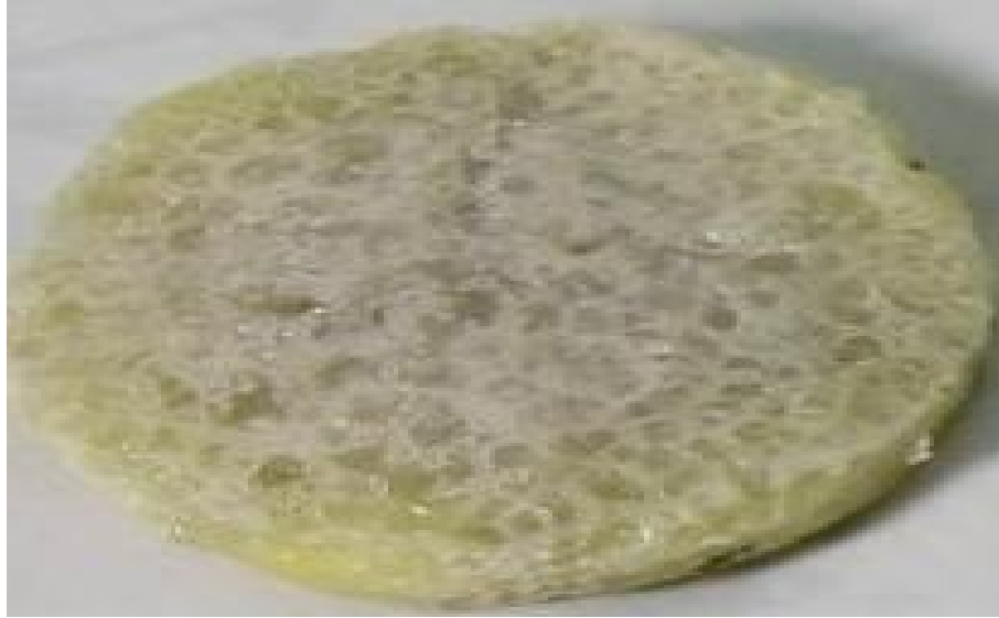
الشكل (6-a) صورة النموذج Styropore مذاب بالبنزين
