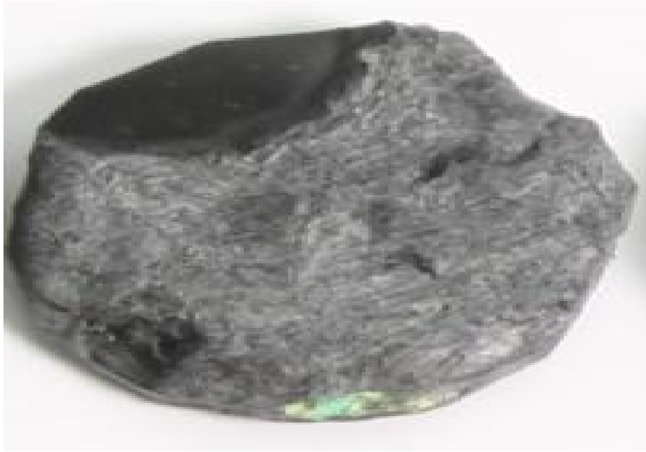
الشكل (6-c) صورة النموذج styropore أضيف اليه (7.5%) من دقائق الكربون
