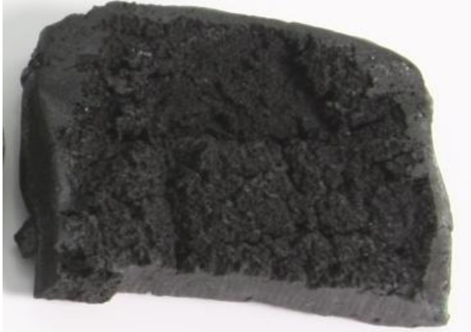
الشكل (6-f) صورة النموذج styropore أضيف اليه (60%) من دقائق الكربون
