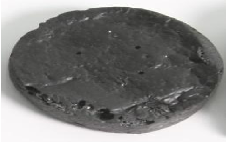
الشكل (6-e) صورة النموذج styropore أضيف اليه (30%) من دقائق الكربون
