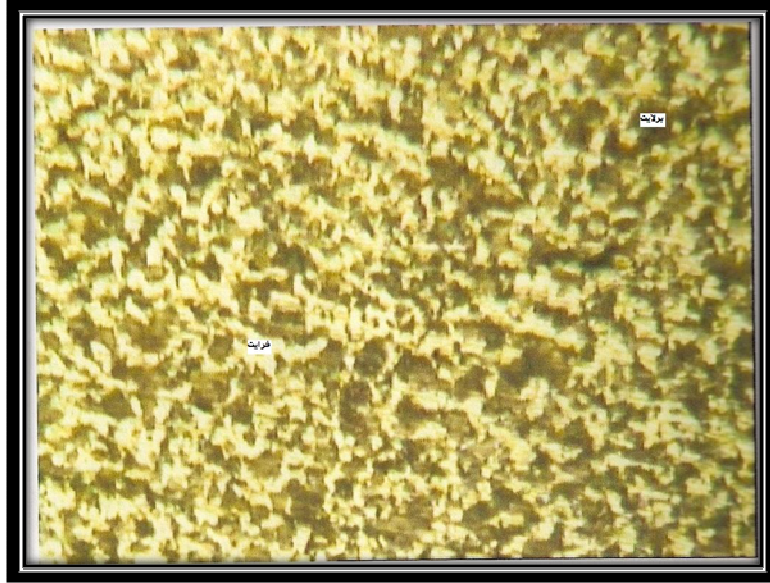
شكل (1) التصوير المجهرى للمعدن الأساس قبل عملية الطلاء (يتكون من برلايت + فرايت) قوة التكبير 125X
