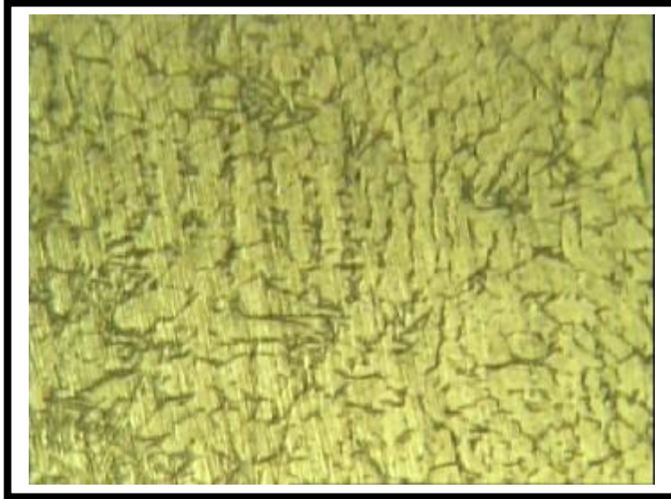
شكل (5) البنية المجهرية لعينة من خلط العينات و بنسب خلط مختلفة
