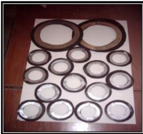
الشكل (3): صورة فوتوغرافية توضح الحلقات المستوية الموضوعة داخل المرشحات البيولوجية اللاهوائية
