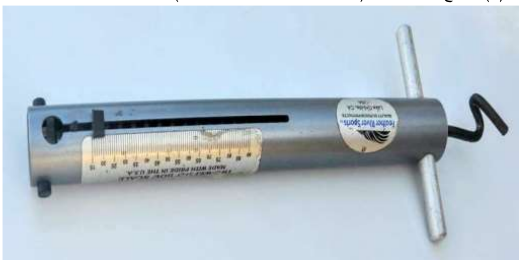
الشكل (١) يوضح جهاز قياس قوة الشد (السحب)
