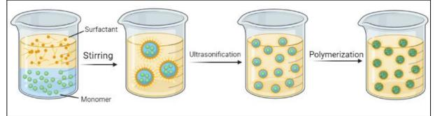
Figure 3: Inverse mini emulsion polymerization
