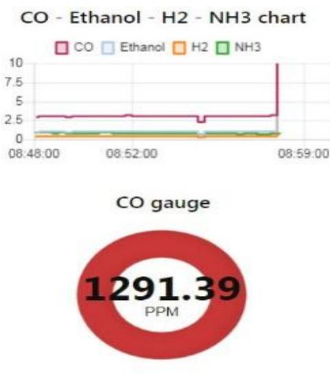
FIG. 16: HIGH LEVEL CONCENTRATION OF CO GAS IN THE CASTING WORKSHOP
