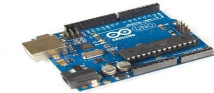
FIG. 6: ARDUINO UNO MICROCONTROLLER
