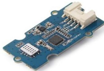
FIG. 4: MULTICHANNEL GROVE GAS SENSOR
