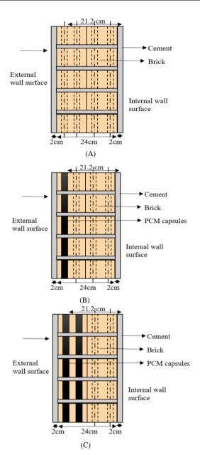
Figure 6. A) traditional wall, B) C1-wall, and C) C2-wall.
