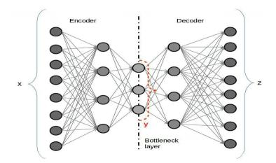
Figure 6 Deep autoencoder & deep autodecoder[23]
