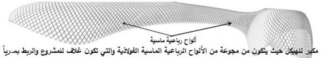
الهيكل القشري الشبكي والذي يشكل القشرة الخارجية للمبنى ويربط المبنى بصرياً
