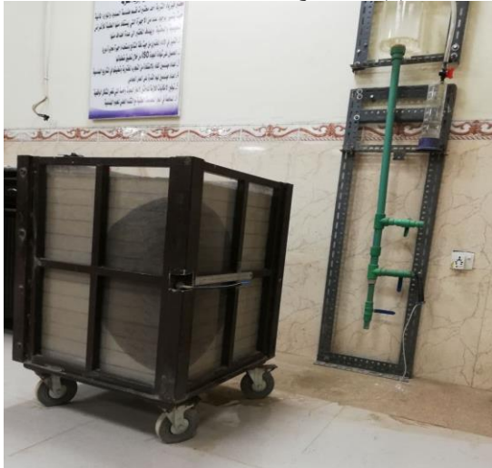
الشكل (1): حاوية التربة ومنظومة تجهيز الماء وموقع المنقط داخل مقد التربة
