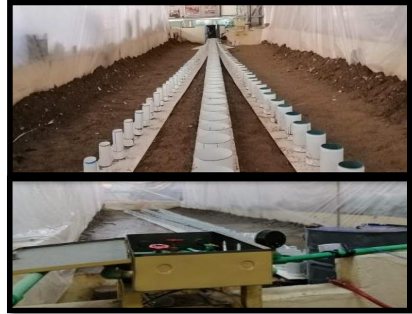
الشكل (1): يوضح الخزان الاسطواني وعلب جمع الماء على امتداد انصاف الأقطار الابتلال الثلاثة وكذلك منظومة تجهيز الماء.
