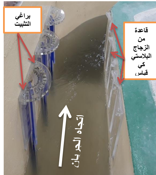
الشكل (3) يوضح فيه شكل المسناة وطريقة التثبيت
