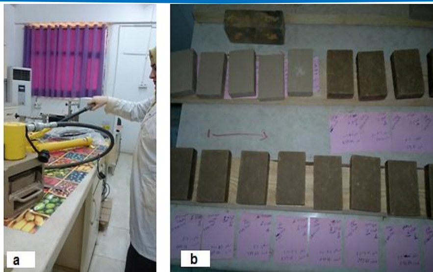
شكل 2: عملية كبس الطابوق في جهاز تصنيع وفحص الطابوق الترابي المضغوط (a): نماذج من الطابوق الترابي المضغوط المنتج أثناء عملية تجفيف (b).
