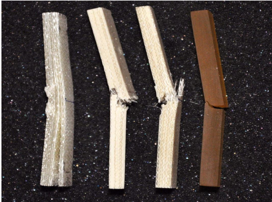
الشكل (3b) حالة الفشل الحاصل في المادة لكل النماذج في اختبار الصدمة
