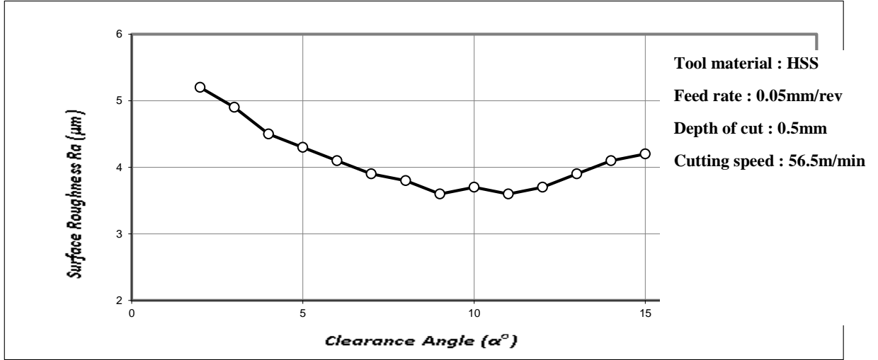
الشكل (4) منحنى الخشونة - الخشونة عند (معدل تغذيةه 0.05mm/rev وعمق قطع 0.5mm وسرعة قطع 56.5m/min)
