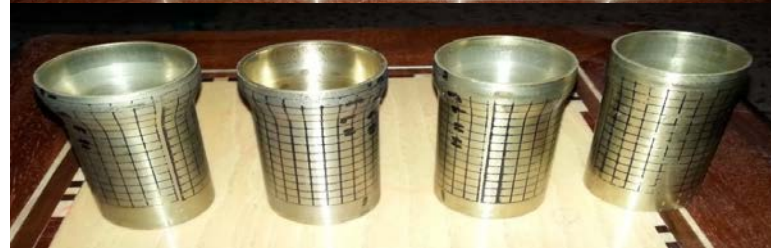
شكل رقم (7) يمثل صور للعينات الخاصة باختبار نسبة التوسيع لعينات ذات سمك نسبي (0.1) ولزاويا نصفية مختلفة
