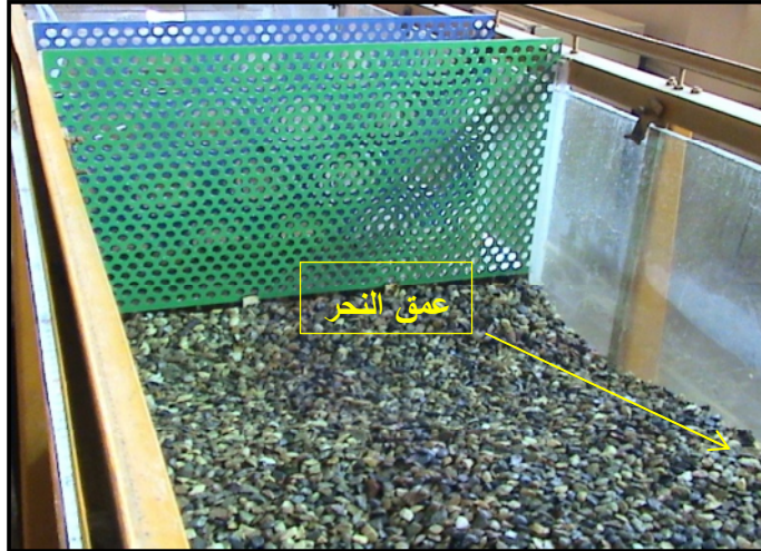
الشكل (1): المخطط التركيبي للقناة وموقع الجدران المنخلية والهدار في القناة
